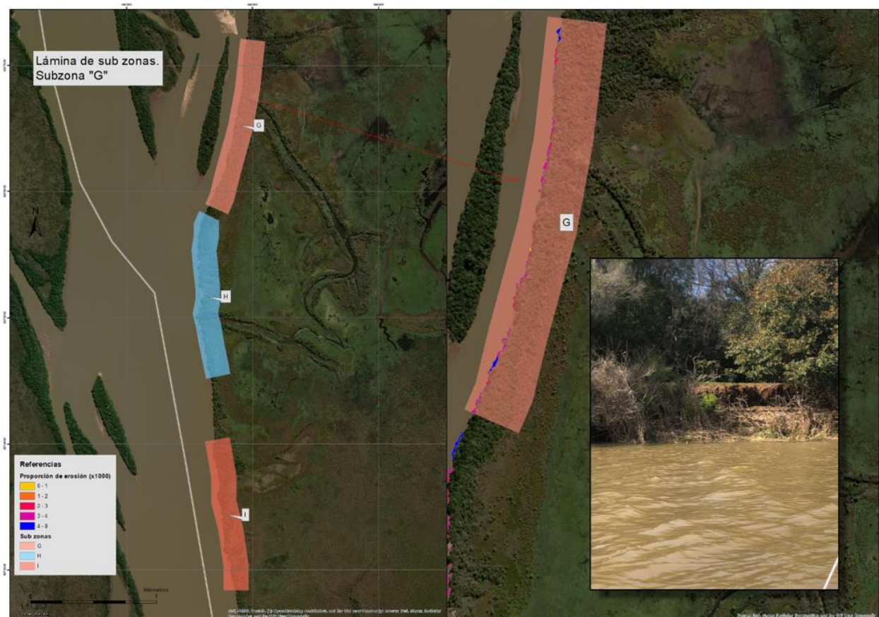
Figura 3.2.3. Detección en la zona G de retroceso de la línea de costa mediante comparación de imágenes satelitales 2013-2017. Fotografía tomada en zona G registrando erosión costera (Agosto 2023).
