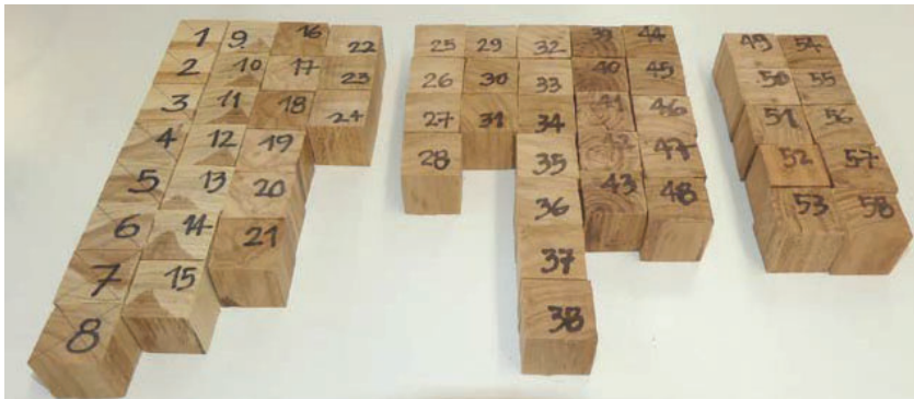
Foto 3. Izq. Probetas con más albura. Centro. Probetas de duramen y/o médula. Der. Probetas de corte radial y tangencial de duramen.
