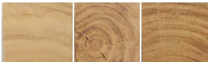
Foto 2. Probetas cúbicas de Acacia negra. Izq. Madera de albura. Centro. Duramen con médula. Der. Duramen
