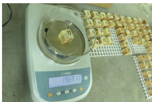
Foto 4: Balanza de 0,001 gramos de precisión
