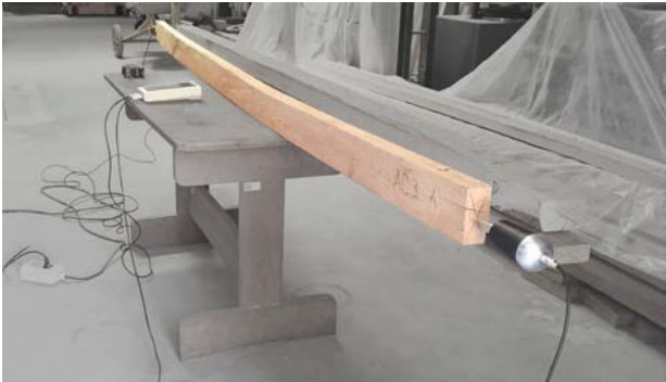
Fig. 3 Ensayo no destructivo en vigas de Acacia negra.
