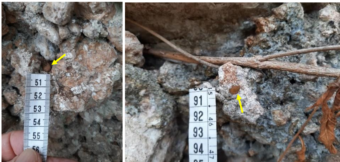
Dos cantos rodados incluidos en la matriz del hormigón (flechas).
