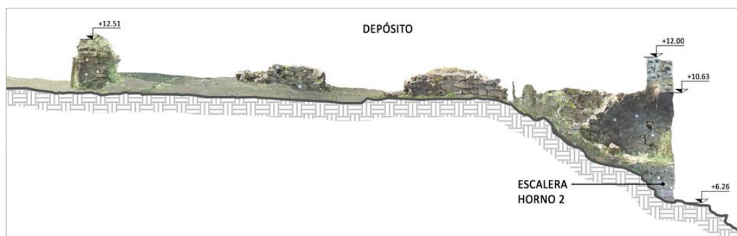
Corte longitudinal del Depósito (Lám. 21 - Corte Sur 2) mostrando que -a noviembre 2022- los niveles máximos de los muros oeste y este son muy similares (+12,51 y +12,00 m, respectivamente).
