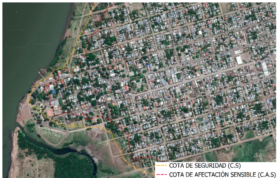
Imagen: cota de seguridad y afectación sensible Bella Unión
